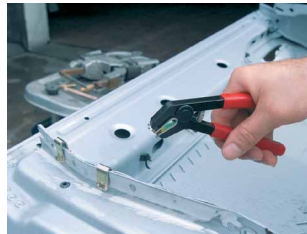
2. Надеть зажим на соединяемые листы металла до упора и отпустить цапгу.
