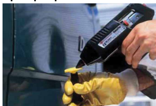
Ремонт боковой поверхности кузова
