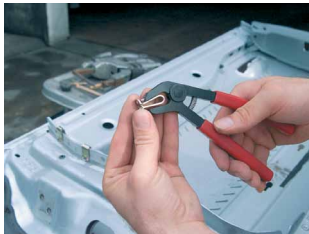
1. Вставьте фиксирующую скобу в клещи и раскройте зажим.
