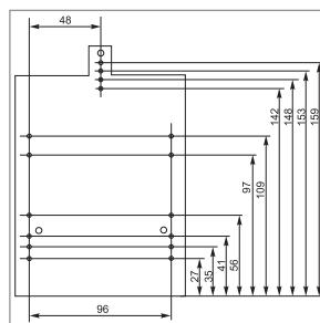
Установка электросчетчика внутрь корпуса осуществляется на DIN-рейку или на монтажную панель. Монтажная панель имеет отверстия под различные типоисполнения электросчетчиков:
