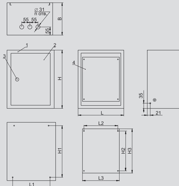
Расположение установочных отверстий Панель монтажная
