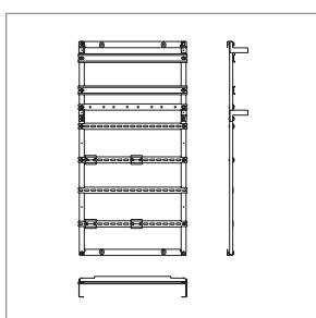
Съемная монтажная рама позволяет без дополнительных переходников установить любые типы однофазных или трехфазных счетчиков.
