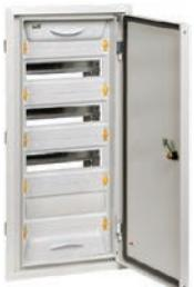
ШРв-48зк-1 36 IP31 UNIVERSAL    | 48             | Корпус: 730×352×138.<br>Ниша: 705×330×135 | Расположение отверстий:<br>сверху, снизу,<br>сзади.<br>Масса: 7,66 кг  | RAL7035<br>RAL9010<br>RAL9005 | MKM12-V-48-31-ZK-U<br>MKM13-V-48-31-ZK-U<br>MKM11-V-48-31-ZK-U       |
