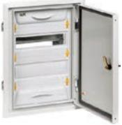
ШРв-24зк-1 36 IP31 UNIVERSAL     | 24             | Корпус: 480×352×138.<br>Ниша: 455×330×135 | Расположение отверстий:<br>сверху, снизу,<br>сзади.<br>Масса: 5,42 кг  | RAL7035<br>RAL9010<br>RAL9005 | MKM12-V-24-31-ZK-U<br>MKM13-V-24-31-ZK-U<br>MKM11-V-24-31-ZK-U       |
