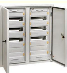
ШРв-2×48зк-1 36 IP31 UNIVERSAL | 96             | Корпус: 730×662×138.<br>Ниша: 705×640×135 | Расположение отверстий:<br>сверху, снизу,<br>сзади.<br>Масса: 14,01 кг | RAL7035<br>RAL9010<br>RAL9005 | MKM12-V-2x48-31-ZK-U<br>MKM13-V-2x48-31-ZK-U<br>MKM11-V-2x48-31-ZK-U |
