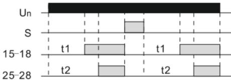
Рисунок 4 – Функциональная диаграмма реле
