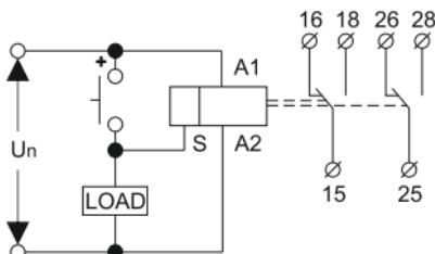
Рисунок 3 – Возможность подключения нагрузки к контактам S-A2
