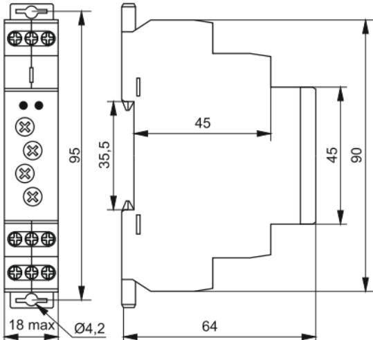
Рисунок 1 – Габаритные и установочные размеры реле
