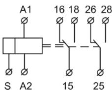
Рисунок 2 – Схема электрическая реле
