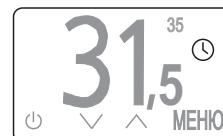
Иконка **ЧАСЫ** говорит о работе функции предварительного прогрева или ограничения на частоту вкл. / откл. реле.
