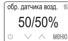
Возможная причина: произошел обрыв или короткое замыкание в цепи датчика, помехи от силовых проводов.
