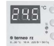
Потім починається індикація температури датчика. Про включення навантаження сигналізує світіння червоного світлодіода.
